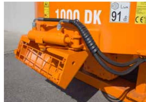
Die links und rechts verfügbaren Auswurföffnungen lassen sich mittels Hebelfunktion bedienen.
