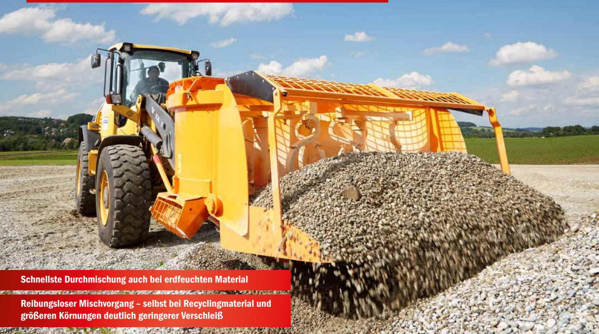
Schnellste Durchmischung auch bei erdfeuchten Material
